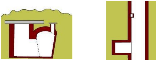
Figuur 3. Een doorsnede en bovenaanzicht van een grote nooduitgang (uitklim nis) en een kleine luchtkoker in een gang.
