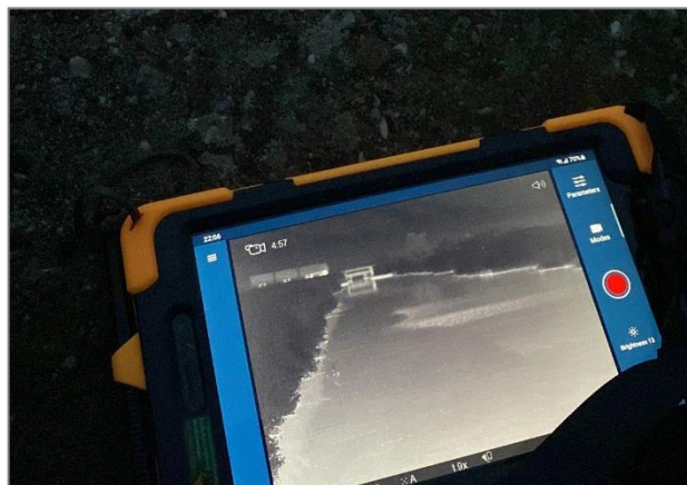
Afbeelding 2.1 | Tijdens routetellingen op donkere plekken zijn warmtebeeldcamera's gebruikt om vliegrichting te bepalen.
