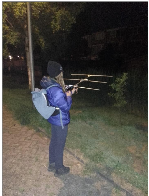
Afbeelding 2.7 | Met een kleinere handantenne kunnen gezenderde dieren tot op gebouwniveau worden opgespoord.
