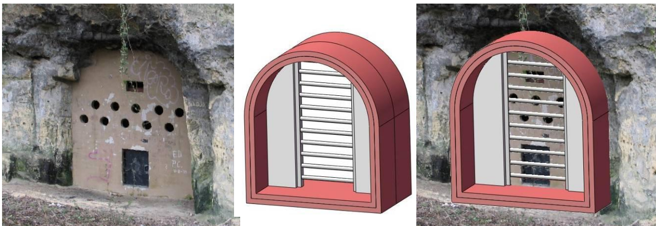
Figuur 60: Een toepassingsvoorbeeld van een vleermuisvriendelijke afsluiting. Deze afsluiting bestaat uit een frame wat iets buiten een mergelgroeve uitsteekt en minimaal 1 meter in een groeve doorloopt. In het frame worden vleermuisvangplekken aangebracht (bv. de holle bakstenen uit figuur 59). In het frame bevindt zich een hekwerk met horizontale spijlen wat van boven tot beneden loopt. Dit hekwerk dient minimaal 1 meter breed te zijn. De spijlen zijn elk met beton verstevigd (zie § 9.1.4) en hebben onderling een afstand van ongeveer 15 centimeter om voldoende luchtstroming te garanderen.
